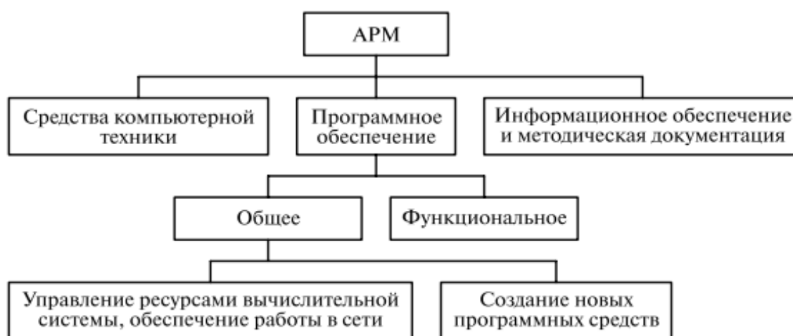
Рис. 1.1. Структура автоматизированного рабочего места специалиста
